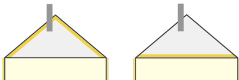
Isolatie in de helling van het dak.
